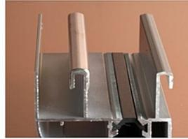
Netoyez le Rail et y mettre un lubrifiant pour Démouler facilement...!
